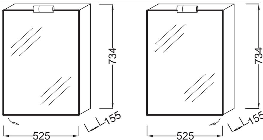
Спецификация продукта: Зеркальный шкаф. EB879. Коллекция: ODEON UP. РАЗМЕРЫ (СМ): 52,50 x 15,50 x 73,50 см. ВЕС: 14 кг. МАТЕРИАЛ: Лак. РЕШЕНИЕ ХРАНЕНИЯ: Дверцы. ФИКСАЦИЯ: Установщику понадобится набор крепежей для монтажа на стену.
